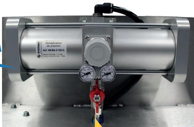
**Vanne manuelle** permettant d'utiliser le surpresseur
