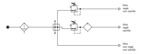
filtre-régulateur distributeur régulateur lubrifiant filtre fin air comprimé
