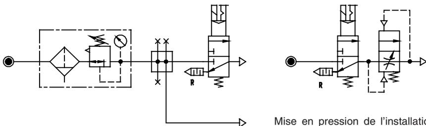
Les installations d'air comprimé ou certaines parties peuvent être mises en ou hors circuit et décomprimées.
