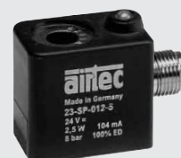
Bobine avec raccorde- ment M-12, 2,5 W, LED et protection électrique intégrée 23-SP-012-5-O32 Page 4.280
