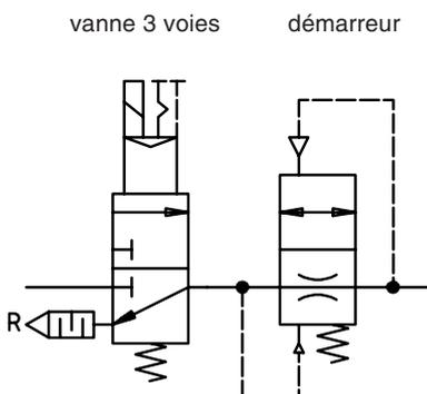
Mise en pression de l'installation par mise en fermeture de la vanne de démarrage.
