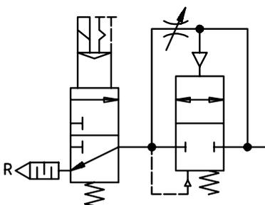
Mise en pression de l'installation par mise en fermeture de la vanne de démarrage.
